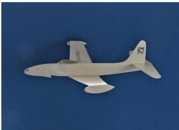
アエルマッキ MB-326(Aermacchi MB-326)はイタリアのアエルマッキ社が開発したジェット練習機および攻撃機。機体は単純かつ頑丈なエアフレームをベースにしており、タンデム複座式のコックピットは与圧化されている。主翼は低翼配置の直線翼で、その翼端には増槽が装備され、付け根にはエンジン吸気口が設けられている。降着装置が短いため、離着陸時に尾部を滑走路にこすらないよう後部胴体には尾輪が設けられている。
