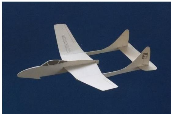
バンパイアのプロトタイプ、英国のデハビランド社の DH100 は 1943 年に初飛行している。ジェットエンジンを搭載するためジェットの排気をスムーズに後方へ流し、かつ機体重量の軽減を図るため、双ブーム形式で後部にジェットエンジンを装備した短い胴体と尾翼をつなげることにし双ブームジェット戦闘機の始まりである。
